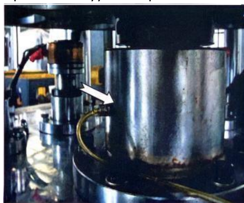
Смазка втулок качающихся рычагов вакуумных присосок
